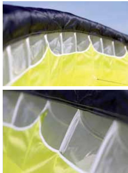
Le bord d'attaque de type shark-nose (« Airscope » chez Advance) et un détail de la qualité de fabrication, ultra aboutie.
