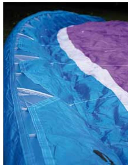
**Le bord d'attaque avec le système d'ouvertures VO de Gradient, pour optimiser la pression interne. En bas, les joncs dans un solide fourreau, pour protéger le tissu.**
